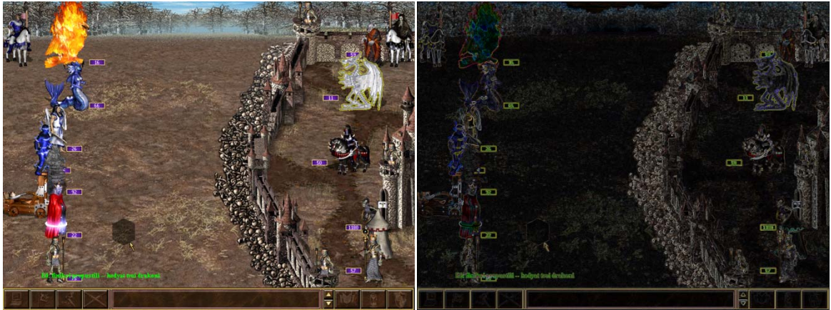
Рис. 1. Исходное изображение (слева) и результат применения к нему оператора Собела (справа)
